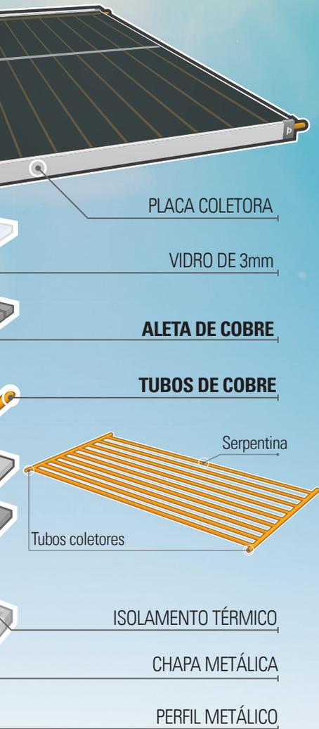
As fitas de cobre apresentam excelente desempenho nas operações de soldagem, visto que receberão a selagem dos tubos de cobre em sua superfície. Um outro ponto muito importante é a condutibilidade térmica do cobre, superior à dos demais metais utilizados para esta aplicação, bem como sua excelente resistência à corrosão atmosférica.
